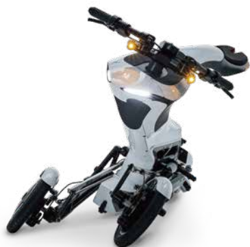
3輪構造&前2輪リーン機能を実装 3輪接地で高速域でのコーナリングも安心
