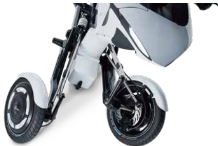
前輪独立懸架リーンサスペンション 可変式差動リーンダンパー
